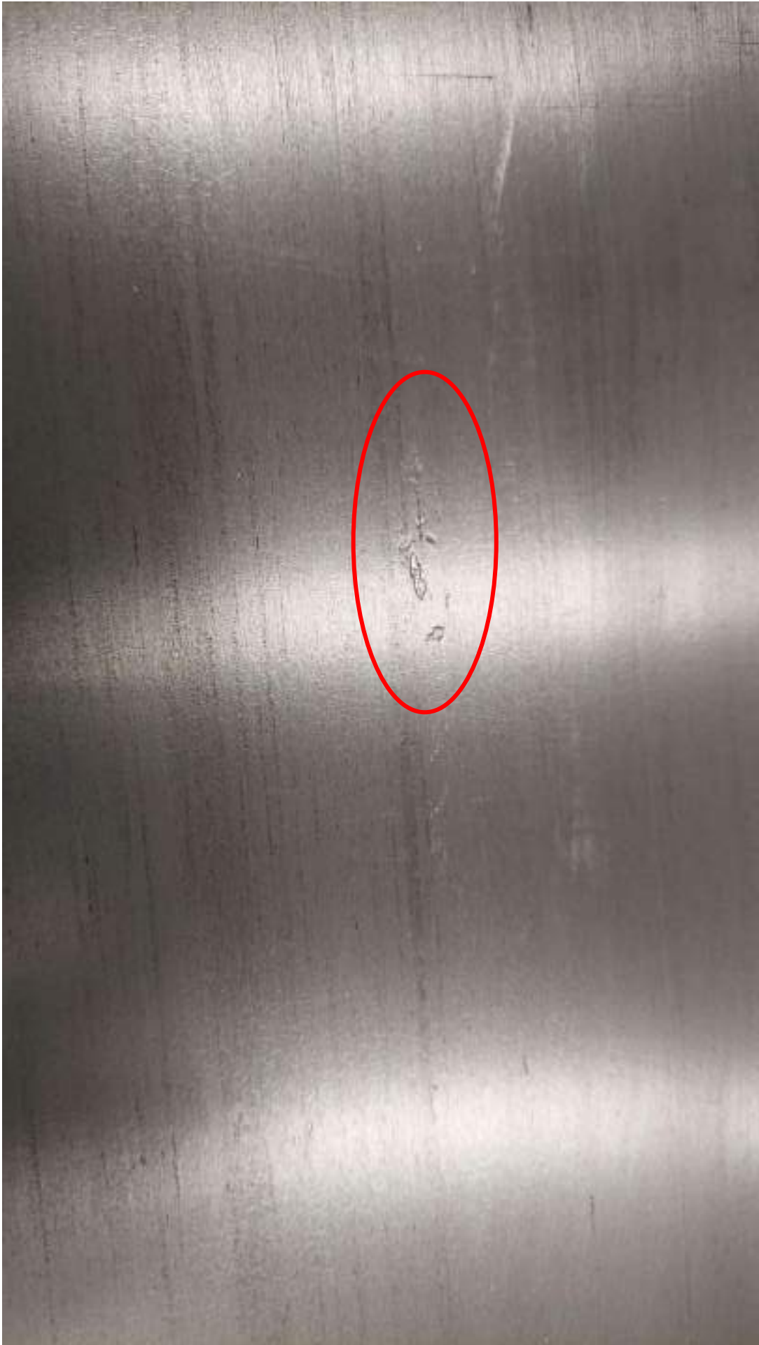
Додаток фото 6 (дефект від прокату)
