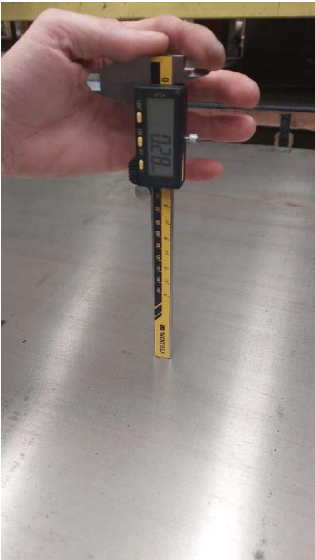
Додаток фото 10 (вимірювання глибини дефекту типу раковина)
