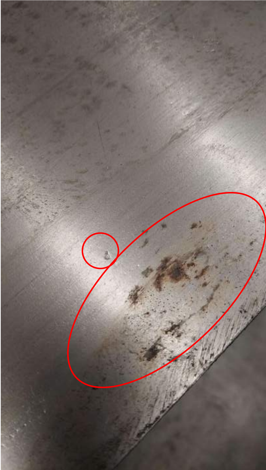
Додаток фото 12 (дефект типу раковина та корозія)
